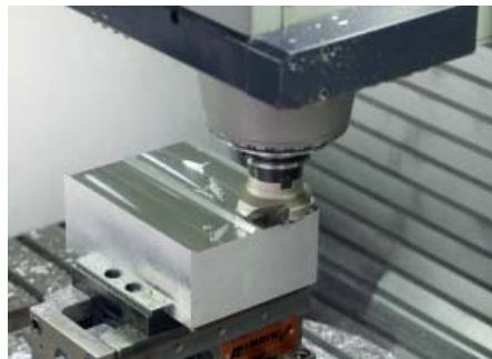
Mittlere Leistungsaufnahme der Antriebe beim Planschruppen Messerkopf: D = 60 \text{ mm} , Drehzahl: 4100 \text{ U/min} , Tiefenzustellung: 4 \text{ mm}
