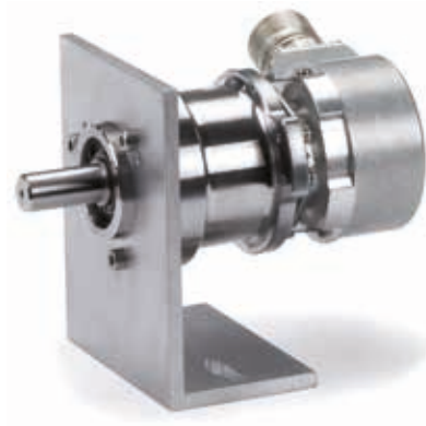
带EQN 400的轴承组件 最大轴载荷： 轴向 150 N 径向 350 N
